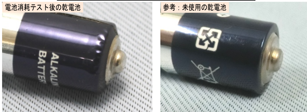
写真5. 電池消耗テストで+端子が膨れた乾電池の例
