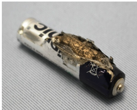
写真5. 電池消耗テストで+端子が膨れた乾電池の例
